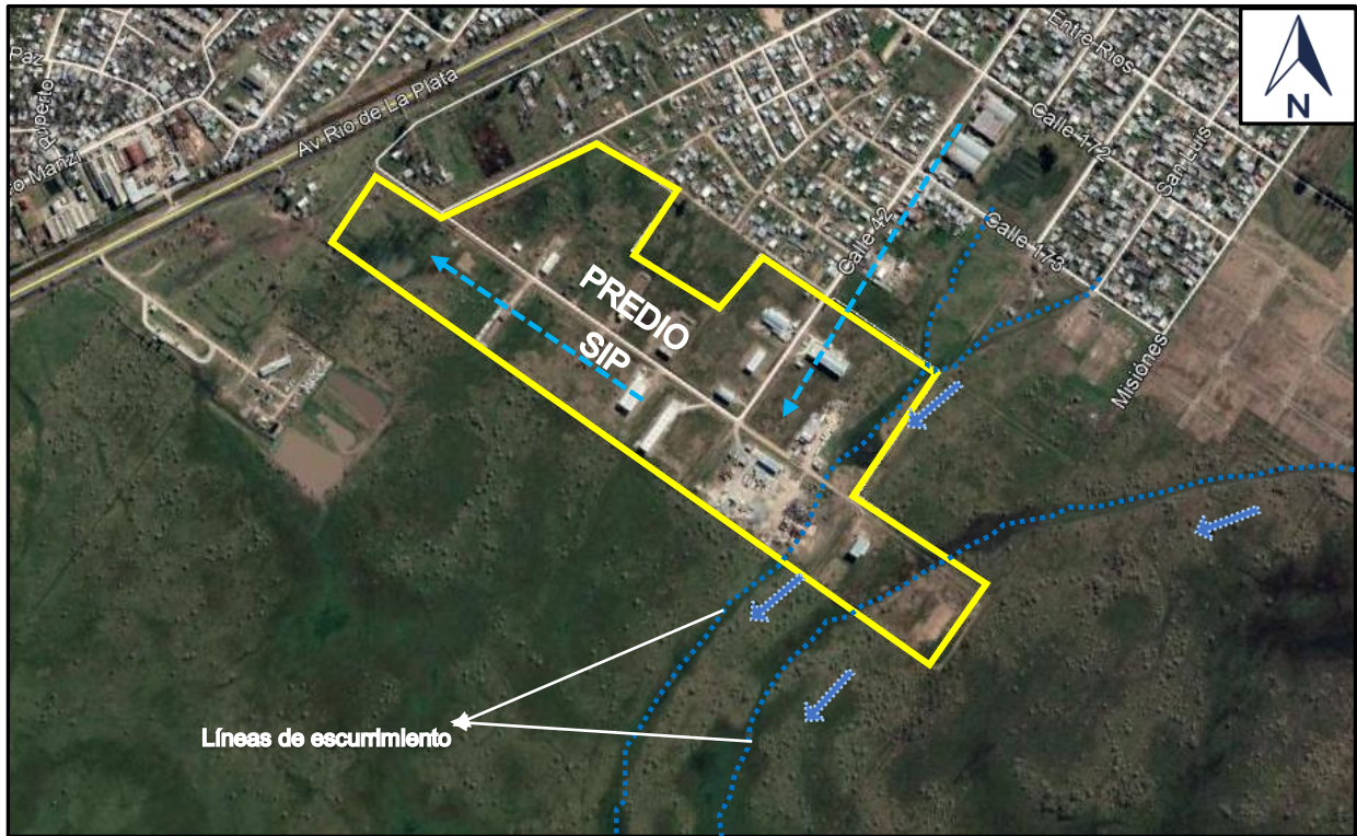
Figura 3: sentido decreciente de pendientes conforme Relevamiento topográfico realizado para obra de desagües pluviales sector industrial planificado. Fuente: Google Earth modificado.
